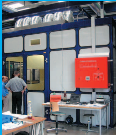
Außenansicht Labor-OP an der Hochschule für Technik + Architektur in Luzern
