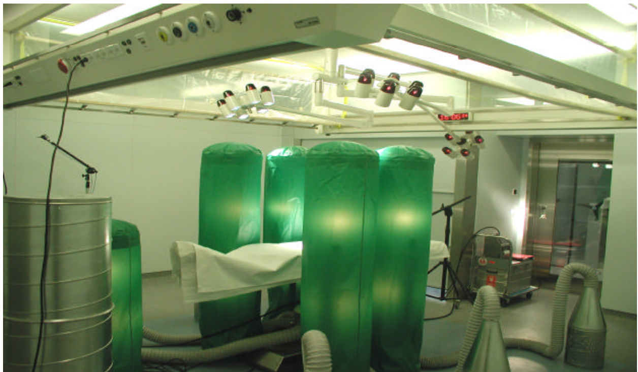
GZO-Spital Wetzikon (Schweiz) Musterlastanordnung für die Qualifizierung eines OP-Saales
